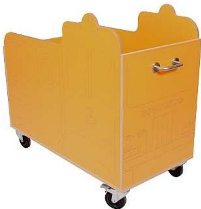
Fabricado en tablero de DM melaminizado de 16 mm de grosor con cantos redondeados y barnizados con barnices no tóxicos. Base en melamina de haya de 19 mm de grosor y cantos en PVC de 2 mm. Dispone de ruedas, de gran resistencia, con freno y asa metálica en el frontal lo que permite desplazarlo fácilmente.
