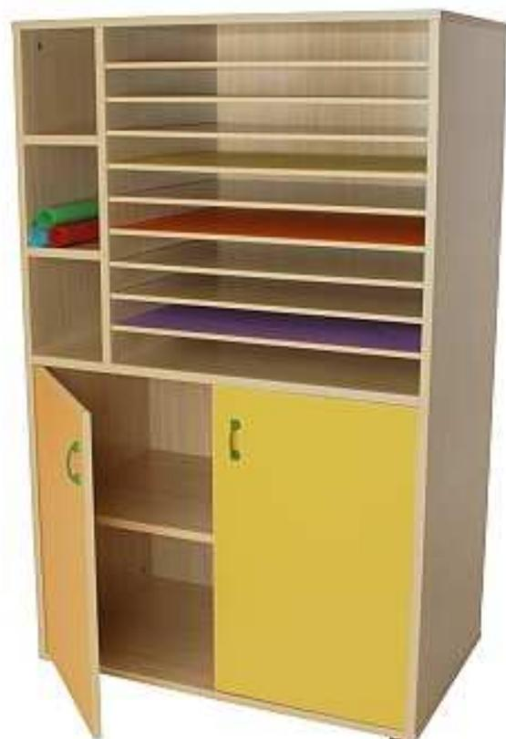
Armario con 2 estantes en la parte inferior y cartulinero de 10 huecos y 3 casillas verticales en la parte superior. Fabricado en melamina de haya, con tableros de 19 mm de espesor, excepto trasera y baldas cartulinero de 10 mm; puertas de 16 mm y cantos de PVC de 2 mm, acabado por las dos caras. Pies niveladores de PVC de 4 cm de diámetro, opción de dos alturas (4 y 8 cm), para evitar la humedad y desniveles que pueda tener el suelo.
