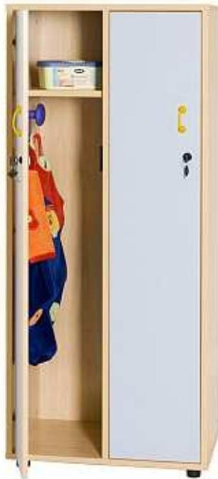
Mueble conjunto de 2 taquillas individuales con balda y una percha por taquilla, fabricado en melamina de haya, con tableros de 19 mm de espesor excepto trasera de 10 mm; puertas de 16 mm y cantos de PVC de 2 mm, acabado por las dos caras. Pies niveladores de PVC de 4 cm de diámetro, con opción de dos alturas (4 y 8 cm), para evitar la humedad y desniveles que pueda tener el suelo. Perchas fabricadas en polipropileno con aristas redondeadas y sistema de doble colgador.
