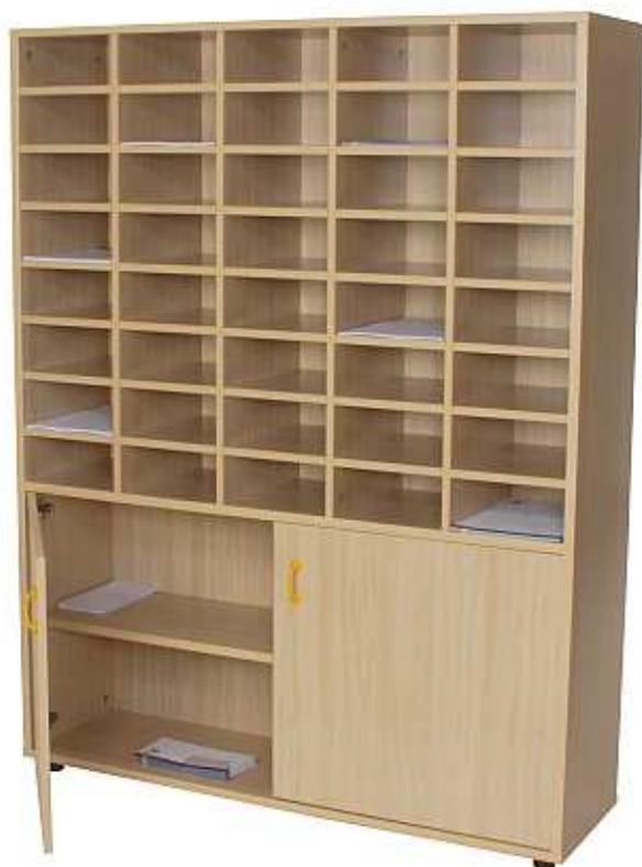
Mueble organizador con armario (interior con 4 casillas) en la parte inferior y casillero con 40 casillas en su parte superior, fabricado en melamina de haya, con tableros de 19 mm de espesor, excepto trasera de 10 mm; puertas y separadores de casillas de 16 mm y cantos de PVC de 2 mm, acabado por las dos caras.
