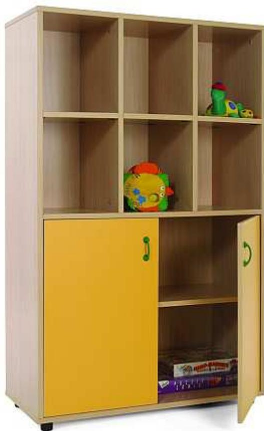
Mueble con puertas (abajo) y 6 casillas en su parte superior, fabricado en melamina de haya, con tableros de 19 mm de espesor, excepto trasera de 10 mm, puertas de 16 mm y cantos de PVC de 2 mm, acabado por las dos caras. Pies niveladores de PVC de 4 cm de diámetro, con opción de dos alturas (4 y 8 cm), para evitar la humedad y desniveles que pueda tener el suelo.
