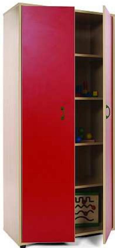
Armario con 2 puertas y 5 estantes en su interior, fabricado en melamina de haya, con tableros de 19 mm de espesor, excepto trasera de 10 mm; puertas de 16 mm y cantos de PVC de 2 mm, acabado por las dos caras. Pies niveladores de PVC de 4 cm de diámetro, con opción de dos alturas (4 y 8 cm), para evitar la humedad y desniveles que pueda tener el suelo. PUERTAS INTERIORES ANTIATRAPAMIENTO DE DEDOS EN SU CIERRE y tiradores de polímero suave (goma) (anti golpes).
