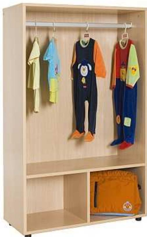
Mueble perchero abierto, con barra para colgar ropa y estantes en la parte inferior, fabricado en melamina de haya, con tableros de 19 mm de espesor excepto trasera de 10 mm. Cantos de PVC de 2 mm acabado por las dos caras. Pies niveladores de PVC de 4 cm de diámetro con opción de dos alturas (4 y 8 cm) para evitar la humedad y desniveles que pueda tener el suelo. Barra con sistema anticaída.
