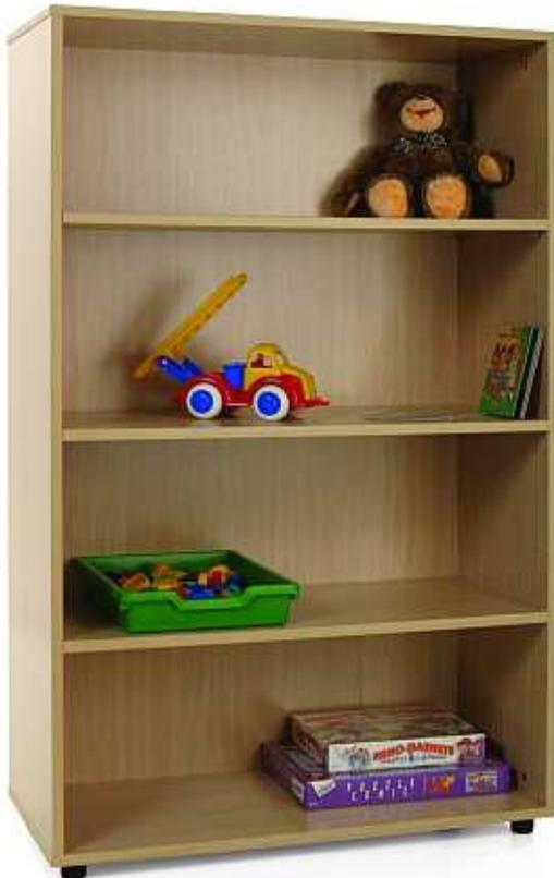
Estantería de 4 estantes fabricada en melamina de haya, con tableros de 19 mm de espesor, excepto trasera de 10 mm y cantos de PVC de 2 mm, acabado por las dos caras. Pies niveladores de PVC de 4 cms de diámetro, con opción de dos alturas (4 y 8 cm), para evitar la humedad y desniveles que pueda tener el suelo.
