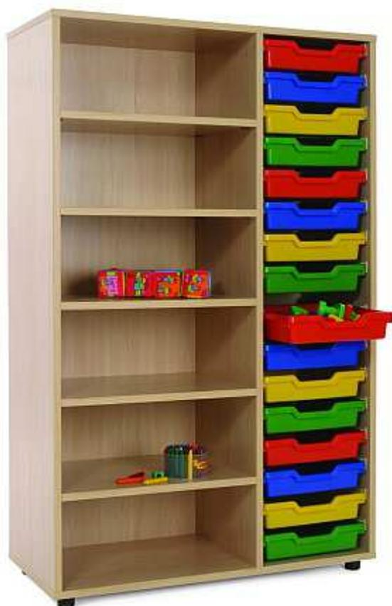
Mueble abierto de 6 estantes y cubetas de colores fabricado en melamina de haya, con tableros de 19 mm de espesor, excepto trasera de 10 mm y cantos de PVC de 2 mm, acabado por las dos caras. Pies niveladores de PVC de 4 cm de diámetro, con opción de dos alturas (4 y 8 cm), para evitar la humedad y desniveles que pueda tener el suelo.
