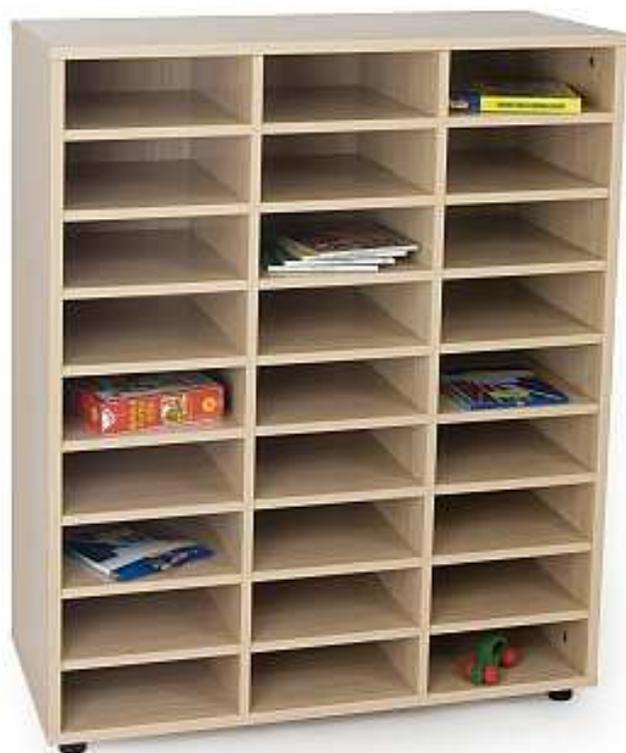
Mueble casillero con 27 casillas, fabricado en melamina de haya, con tableros de 19 mm de espesor, excepto trasera de 10 mm, y cantos de PVC de 2 mm, acabado por las dos caras. Pies niveladores de PVC de 4 cm de diámetro, con opción de dos alturas (4 y 8 cm), para evitar la humedad y desniveles que pueda tener el suelo. Estos pies pueden ser retirados del mueble para superponer diferentes armarios.
