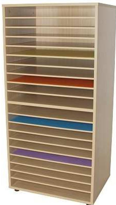
Mueble para cartulinas con 20 huecos, en posición horizontal, fabricado en melamina de haya, con tableros de 19 mm de espesor, trasera y baldas de 10 mm excepto balda central de 19 mm. Cantos de PVC de 2 mm, acabado por las dos caras. Pies niveladores de PVC de 4 cm de diámetro, con opción de dos alturas (4 y 8 cm), para evitar la humedad y desniveles que pueda tener el suelo.
