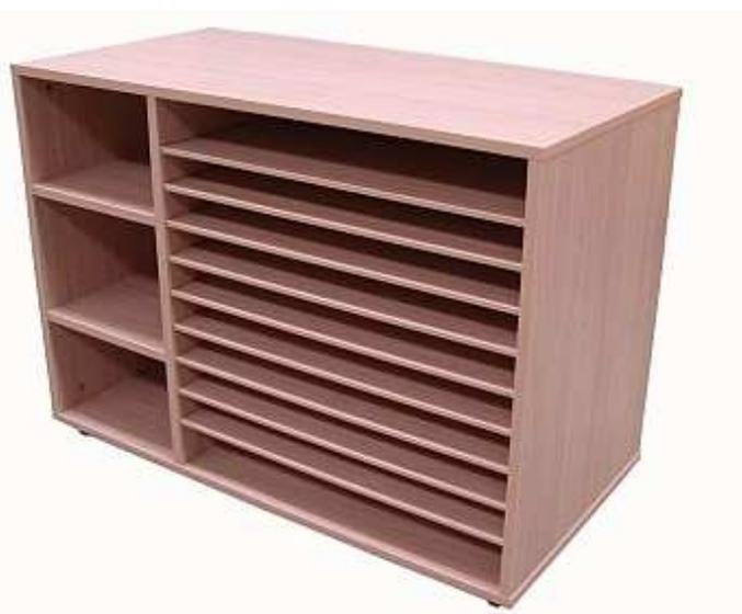
Mueble compuesto por zona estantería con 3 estantes y cartulinero con 10 huecos en posición horizontal. Fabricado en melamina de haya, con tableros de 19 mm de espesor y baldas cartulinero y trasera de 10 mm. Cantos de PVC de 2 mm, acabado por las dos caras. Pies niveladores de PVC de 4 cm de diámetro, con opción de dos alturas (4 y 8 cm), para evitar la humedad y desniveles que pueda tener el suelo.
