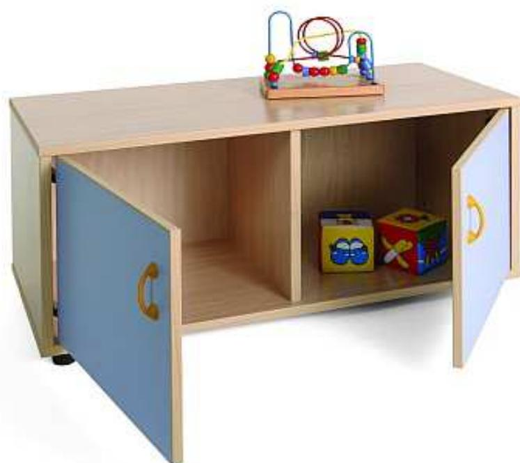
Mueble con puertas y 2 casillas fabricado en melamina de haya, con tableros de 19 mm de espesor, excepto trasera de 10 mm; puertas de 16 mm y cantos de PVC de 2 mm, acabado por las dos caras. Pies niveladores de PVC de 4 cm de diámetro, con opción de dos alturas (4 y 8 cm), para evitar la humedad y desniveles que pueda tener el suelo. Estos pies pueden ser retirados del mueble para poder superponer diferentes armarios.
