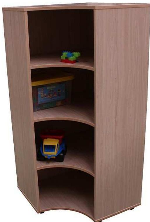
Mueble rinconero con 4 estantes. Fabricado en melamina de haya, con tableros de 19 mm de espesor y trasera de 10 mm. Cantos de PVC de 2 mm, acabado por las dos caras. Pies niveladores de PVC de 4 cm de diámetro, con opción de dos alturas (4 y 8 cm), para evitar la humedad y desniveles que pueda tener el suelo.
