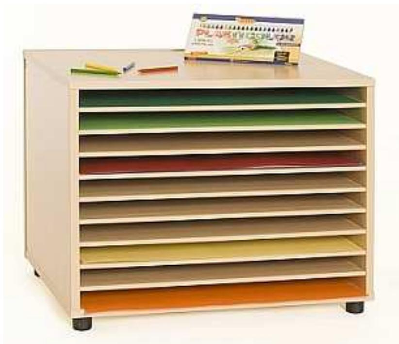
Mueble para cartulinas con 10 huecos, en posición horizontal, fabricado en melamina de haya, con tableros de 19 mm de espesor, separadores intermedios fabricados en 10 mm. Cantos de PVC de 2 mm, acabado por las dos caras. Pies niveladores de PVC de 4 cm de diámetro, con opción de dos alturas (4 y 8 cm), para evitar la humedad y desniveles que pueda tener el suelo. Disponible con ruedas.
