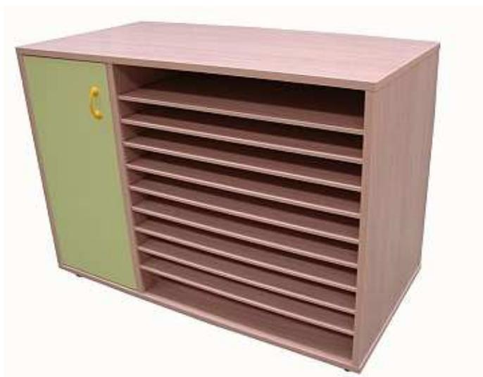
Mueble compuesto por zona armario con 3 estantes en su interior y cartulinerero con 10 huecos en posición horizontal. Fabricado en melamina de haya, con tableros de 19 mm de espesor y baldas cartulinerero y trasera de 10 mm. Cantos de PVC de 2 mm, acabado por las dos caras. Pies niveladores de PVC de 4 cm de diámetro, con opción de dos alturas (4 y 8 cm), para evitar la humedad y desniveles que pueda tener el suelo.
