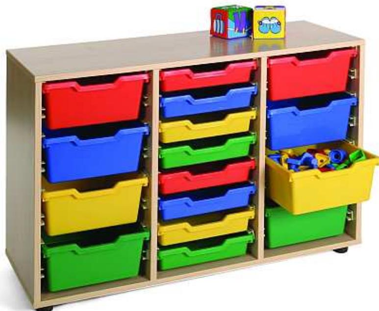
Mueble cubetero fabricado en melamina de haya, con tableros de 19 mm de espesor, excepto trasera de 10 mm y cantos de PVC de 2 mm, acabado por las dos caras. Pies niveladores de PVC de 4 cms de diámetro, con opción de dos alturas (4 y 8 cm), para evitar la humedad y desniveles que pueda tener el suelo. Estos pies pueden ser retirados del mueble para poder superponer diferentes armarios.
