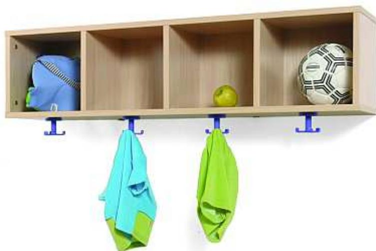
Casillero con 4 casillas fabricado en melamina de haya, con tableros de 19 mm de espesor, excepto trasera de 10 mm; separadores de casillas de 19 mm. Cantos de PVC de 2 mm., acabado por las dos caras. Dispone de 4 perchas giratorias fabricadas en polipropileno con aristas redondeadas y sistema triple colgador, para poder colgar la vestimenta del niño. Mueble desmontable, con bordes redondeados para prevención de cortes o heridas.
