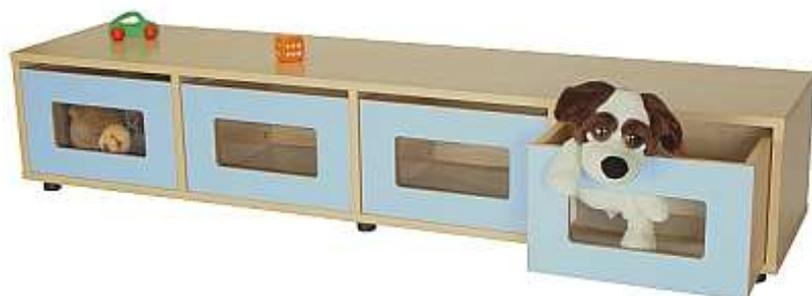
Fabricado en melamina de haya, con tableros de 19 mm de espesor, con cantos de PVC de 2 mm, acabado por las dos caras. Frentes de cajón en DM melaminizado de 16 mm con cantos redondeados y barnizados con barniz no tóxico, con ventana central en metacrilato, permitiendo ver el interior del cajón sin necesidad de abrirlo.
