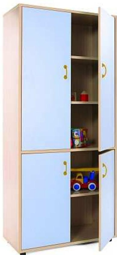
Armario con 4 puertas y 5 estantes fabricado en melamina de haya, con tableros de 19 mm de espesor, excepto trasera de 10 mm; puertas de 16 mm y cantos de PVC de 2 mm, acabado por las dos caras. Pies niveladores de PVC de 4 cm de diámetro, con opción de dos alturas (4 y 8 cm), para evitar la humedad y desniveles que pueda tener el suelo.
