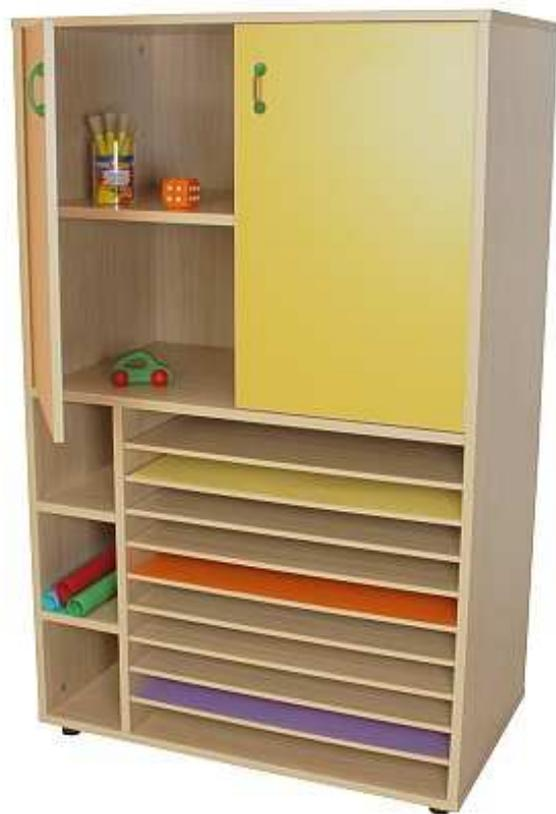
Cartulinerero de 10 huecos y 3 casillas verticales en la parte inferior y armario con 2 estantes en su parte superior. Fabricado en melamina de haya, con tableros de 19 mm de espesor, excepto trasera y baldas cartulinerero de 10 mm; puertas de 16 mm y cantos de PVC de 2 mm, acabado por las dos caras. Pies niveladores de PVC de 4 cm de diámetro, con opción de dos alturas (4 y 8 cm), para evitar la humedad y desniveles que pueda tener el suelo.
