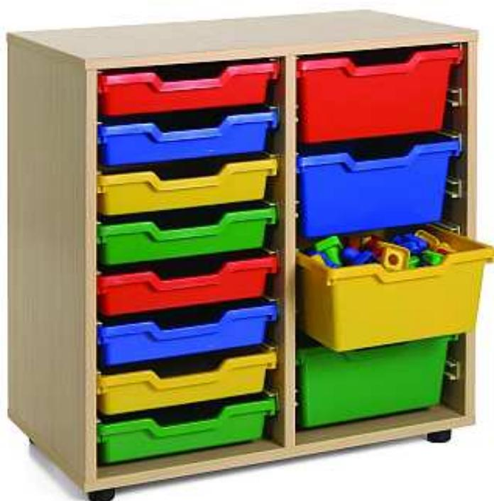
Mueble cubetero fabricado en melamina de haya, con tableros de 19 mm de espesor, excepto trasera de 10 mm y cantos de PVC de 2 mm, acabado por las dos caras. Pies niveladores de PVC de 4 cms de diámetro, con opción de dos alturas (4 y 8 cms.), para evitar la humedad y desniveles que pueda tener el suelo. Estos pies pueden ser retirados del mueble para poder superponer diferentes armarios. Mueble desmontable, con bordes redondeados para prevención de cortes o heridas.
