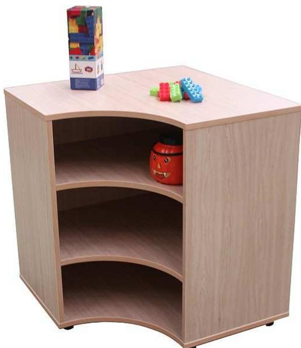
Mueble rinconero con 3 estantes. Fabricado en melamina de haya, con tableros de 19 mm de espesor y trasera de 10 mm. Cantos de PVC de 2 mm, acabado por las dos caras. Pies niveladores de PVC de 4 cm de diámetro, con opción de dos alturas (4 y 8 cm), para evitar la humedad y desniveles que pueda tener el suelo.
