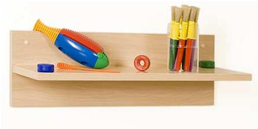
Balda con soporte trasero, fabricada en melamina de haya con tablero de 19 mm y cantos de PVC de 2 mm. Aristas redondeadas. Sistema robusto de fijación a la pared, mediante pasos de taladrado y atornillado.
