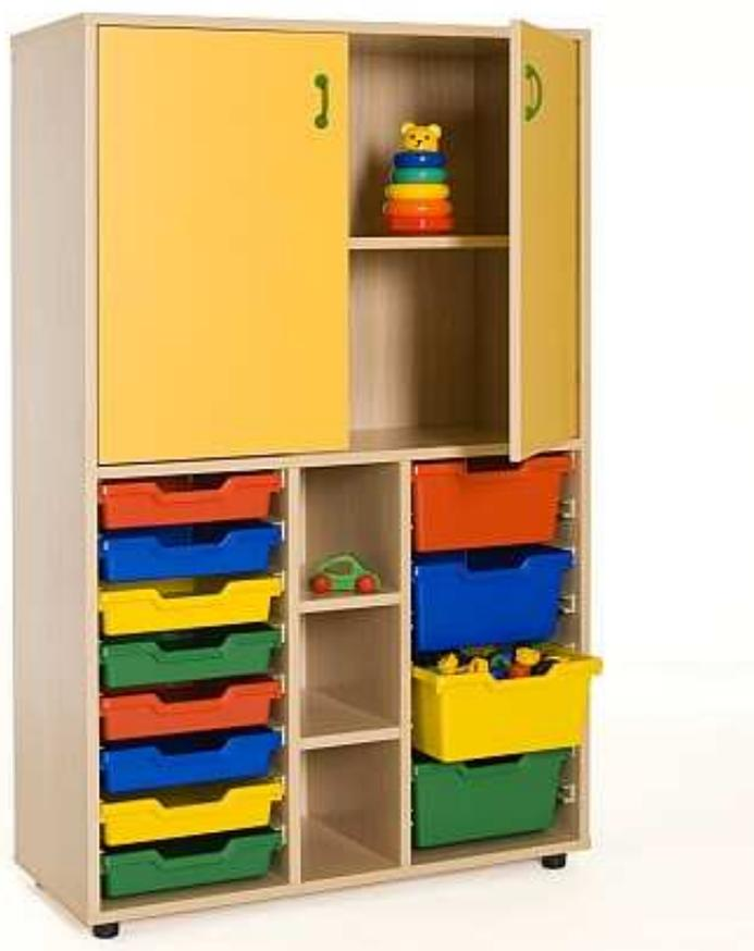
Cubetero abajo y armario con 2 estantes en su parte superior, fabricado en melamina de haya, con tableros de 19 mm de espesor, excepto trasera de 10 mm; puertas de 16 mm y cantos de PVC de 2 mm, acabado por las dos caras. Pies niveladores de PVC de 4 cm de diámetro, con opción de dos alturas (4 y 8 cm) para evitar la humedad y desniveles que pueda tener el suelo.
