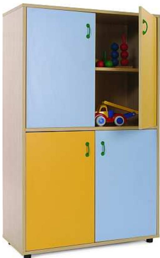
Mueble con 4 puertas y 4 estantes fabricado en melamina de haya, con tableros de 19 mm de espesor, excepto trasera de 10 mm; puertas de 16 mm y cantos de PVC de 2 mm, acabado por las dos caras. Pies niveladores de PVC de 4 cms de diámetro, con opción de dos alturas (4 y 8 cms.), para evitar la humedad y desniveles que pueda tener el suelo.
