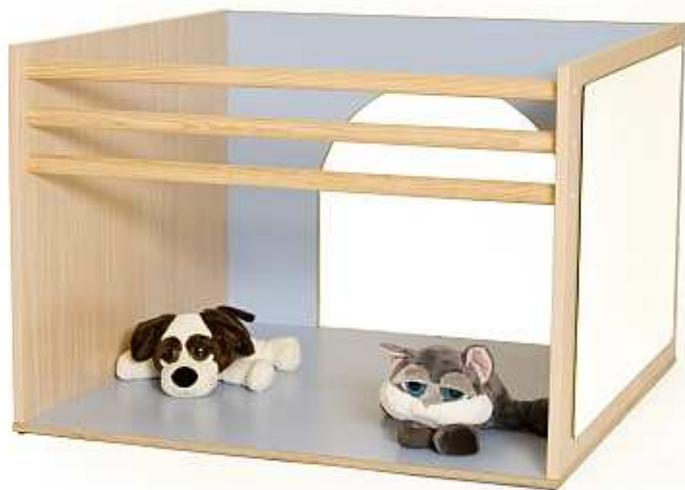
Mueble cubo diseñado para facilitar al niño su motricidad, fabricado en melamina de haya de 19 mm de espesor con cantos de PVC de 2 mm y chudoply (multilaminado de abedul) con placas estratificadas en color a elegir. Dispone de 3 barras de pino macizo (de 35 mm), barnizadas con barniz no tóxico y espejo de seguridad (de 3 mm) con lámina adhesiva lo que impide el desprendimiento en caso de rotura y acceso en las partes laterales.
