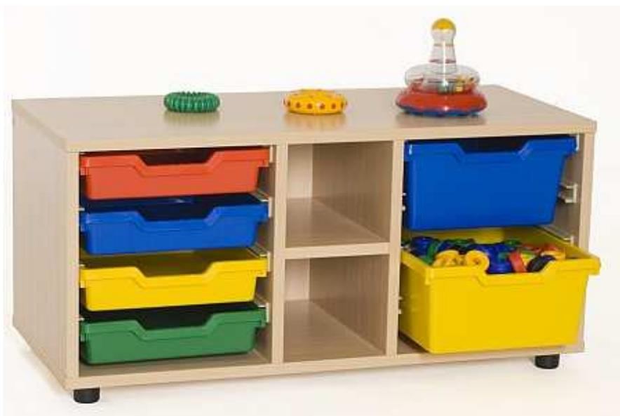
Mueble cubetero con estante central, fabricado en melamina de haya, con tableros de 19 mm de espesor, excepto trasera de 10 mm. Cantos de PVC de 2 mm, acabado por las dos caras. Pies niveladores de PVC de 4 cm de diámetro, con opción de dos alturas (4 y 8 cm), para evitar la humedad y desniveles que pueda tener el suelo. Estos pies pueden ser retirados del mueble para poder superponer diferentes armarios.
