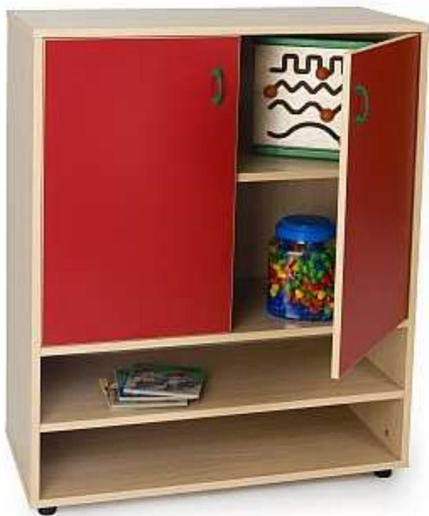
Estantería y armario con 2 estantes, fabricado en melamina de haya, con tableros de 19 mm de espesor, excepto trasera de 10 mm, puertas de 16 mm y cantos de PVC de 2 mm, acabado por las dos caras. Pies niveladores de PVC de 4 cm de diámetro, con opción de dos alturas (4 y 8 cm), para evitar la humedad y desniveles que pueda tener el suelo. Estos pies pueden ser retirados del mueble para superponer diferentes armarios.
