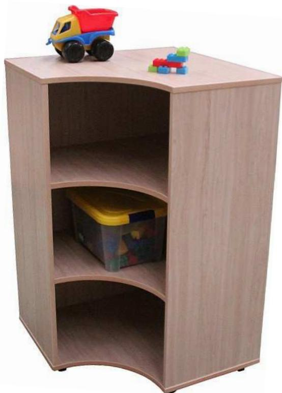
Mueble rinconero con 3 estantes. Fabricado en melamina de haya, con tableros de 19 mm de espesor y trasera de 10 mm. Cantos de PVC de 2 mm, acabado por las dos caras. Pies niveladores de PVC de 4 cm de diámetro, con opción de dos alturas (4 y 8 cm), para evitar la humedad y desniveles que pueda tener el suelo.
