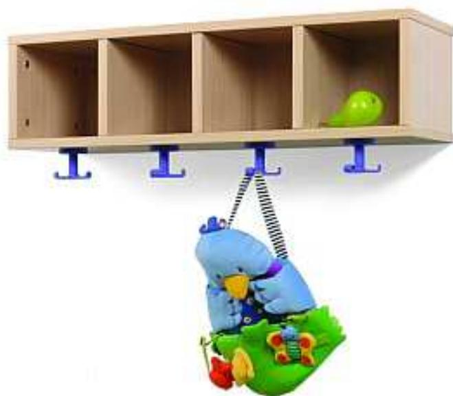
Casillero con 4 casillas fabricado en melamina de haya, con tableros de 19 mm de espesor, excepto trasera de 10 mm; separadores de casillas de 19 mm. Cantos de PVC de 2 mm, acabado por las dos caras. Dispone de 4 perchas giratorias fabricadas en polipropileno con aristas redondeadas y sistema triple colgador, para poder colgar la vestimenta del niño. Mueble desmontable, con bordes redondeados para prevención de cortes o heridas.
