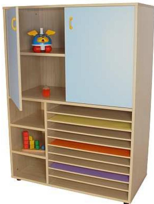
Cartulinero de 10 huecos y 3 casillas verticales en la parte inferior y armario con 2 estantes en su parte superior. Fabricado en melamina de haya, con tableros de 19 mm de espesor, excepto trasera y baldas cartulinero de 10 mm; puertas de 16 mm y cantos de PVC de 2 mm, acabado por las dos caras. Pies niveladores de PVC de 4 cm de diámetro, con opción de dos alturas (4 y 8 cm), para evitar la humedad y desniveles que pueda tener el suelo.
