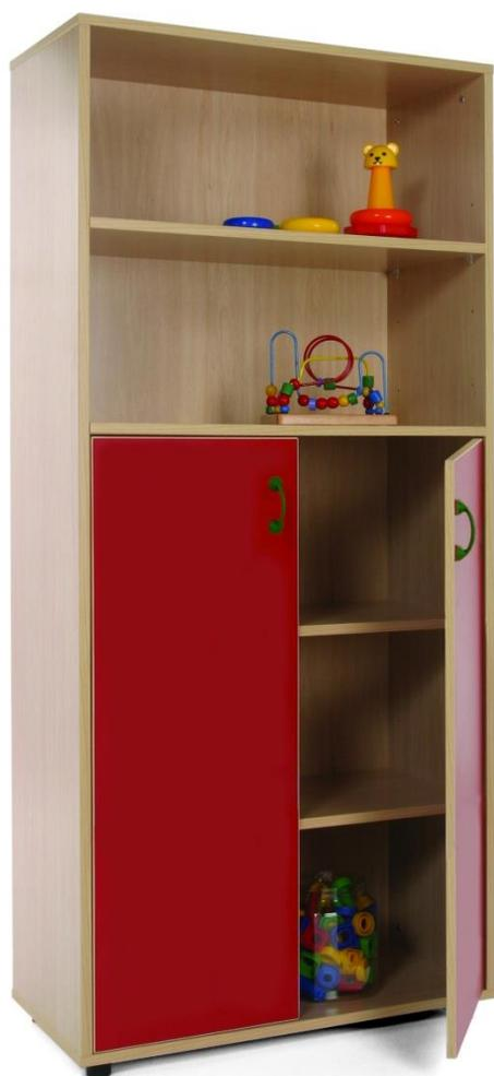
Armario con 3 estantes (abajo) y estantería con 2 estantes en la parte superior, fabricado en melamina de haya, con tableros de 19 mm de espesor, excepto trasera de 10 mm, puertas de 16 mm y cantos de PVC de 2 mm, acabado por las dos caras. Pies niveladores de PVC de 4 cm de diámetro, con opción de dos alturas (4 y 8 cm), para evitar la humedad y desniveles que pueda tener el suelo. Estos pies pueden ser retirados del mueble para superponer diferentes armarios.
