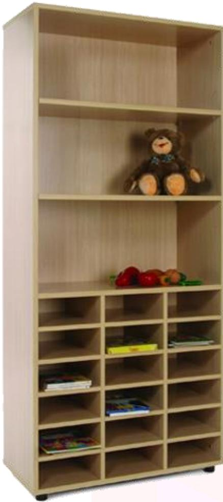
Casillero con 18 casillas (abajo) y estantería con 3 estantes en la parte superior del mueble, con tableros de 19 mm de espesor, excepto trasera de 10 mm. Cantos de PVC de 2 mm, acabado por las dos caras. Pies niveladores de PVC de 4 cm de diámetro, con opción de dos alturas (4 y 8 cm), para evitar la humedad y desniveles que pueda tener el suelo. Estos pies pueden ser retirados del mueble para superponer diferentes armarios.
