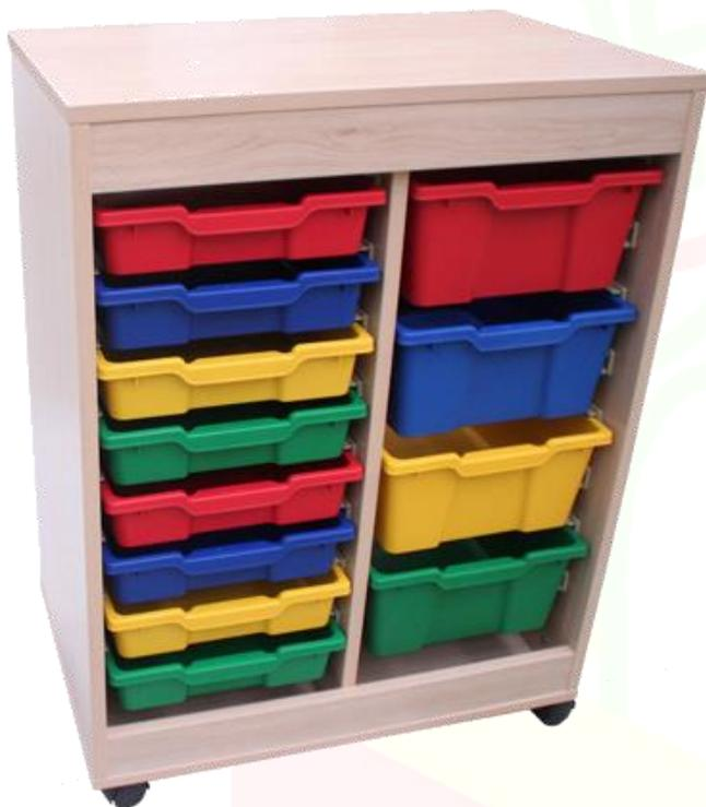
Mueble cubetero doble acceso, fabricado en melamina de haya, con tableros de 19 mm de espesor, excepto trasera de 10 mm y cantos de PVC de 2 mm, acabado por las dos caras. Pies niveladores de PVC de 4 cm de diámetro, con opción de dos alturas (4 y 8 cm), para evitar la humedad y desniveles que pueda tener el suelo. Estos pies pueden ser retirados del mueble para poder superponer diferentes armarios.
