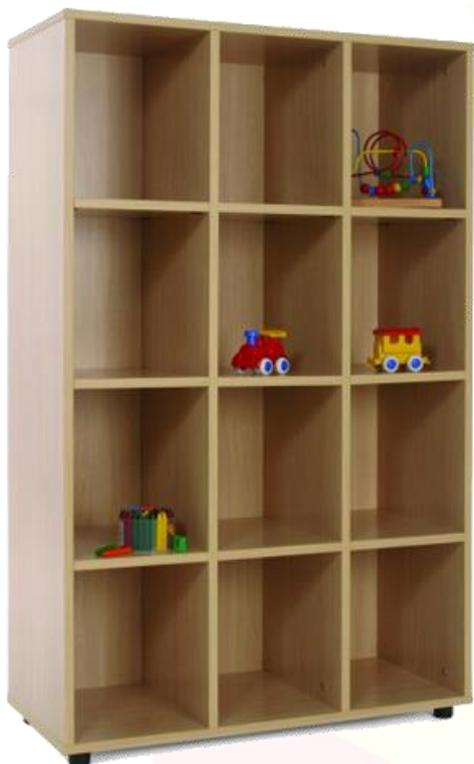
Mueble abierto de 12 casillas, fabricado en melamina de haya, con tableros de 19 mm de espesor, excepto trasera de 10 mm, y cantos de PVC de 2 mm, acabado por las dos caras. Pies niveladores de PVC de 4 cm de diámetro, con opción de dos alturas (4 y 8 cm), para evitar la humedad y desniveles que pueda tener el suelo. Estos pies pueden ser retirados del mueble para superponer diferentes armarios.
