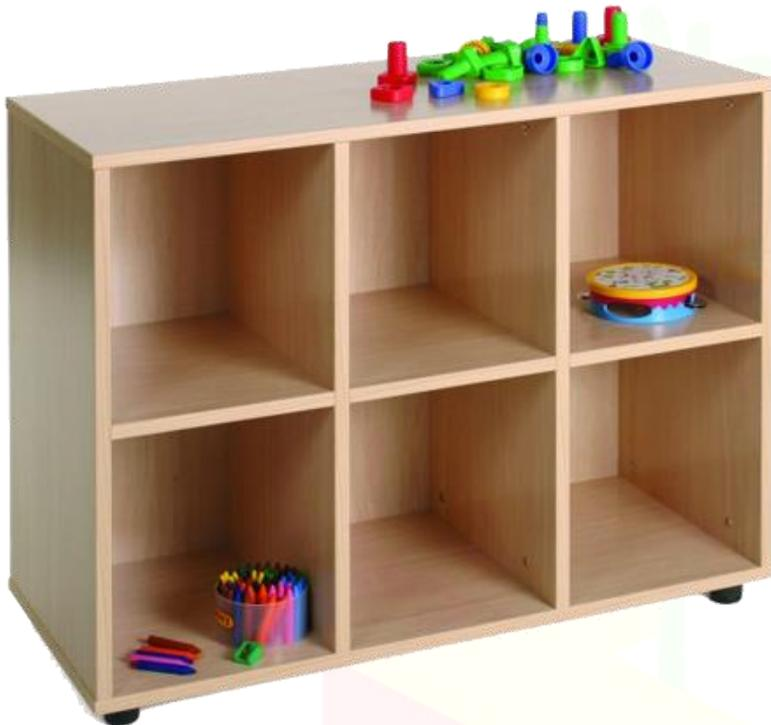
Mueble abierto de 6 casillas fabricado, en melamina de haya, con tableros de 19 mm de espesor, excepto trasera de 10 mm. Cantos de PVC de 2 mm, acabado por las dos caras. Pies niveladores de PVC de 4 cm de diámetro, con opción de dos alturas (4 y 8 cm), para evitar la humedad y desniveles que pueda tener el suelo. Estos pies pueden ser retirados del mueble para poder superponer diferentes armarios.
